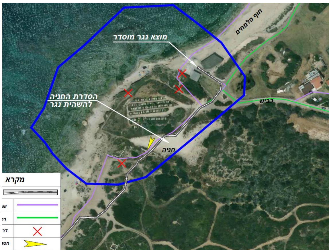
איור 113 - תא 36 מצב מוצע להסדרת ניקוז, ודוגמאות להסדרת השהיית נגר
